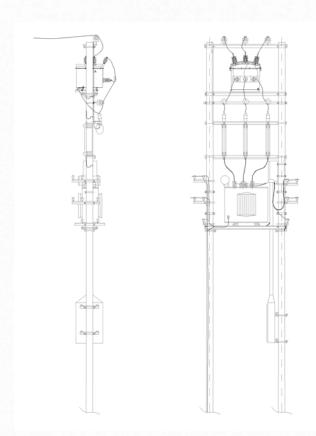
Комплекс устанавливается на границе балансовой принадлежности, подключается к ЛЭП 6(10) кВ через линейный разъединитель, который устанавливается на одной опоре с Высоковольтным модулем ПСС-10-СУ, на соседней опоре монтируется КТП. Расстояние между опорами 1,5-3,5 метра. Две опоры соединены площадкой для обслуживания комплекса (по заказу).
